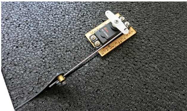
Joonis 5. Tüürpinna liigutamiseks kasutatav mootor ja varras.
