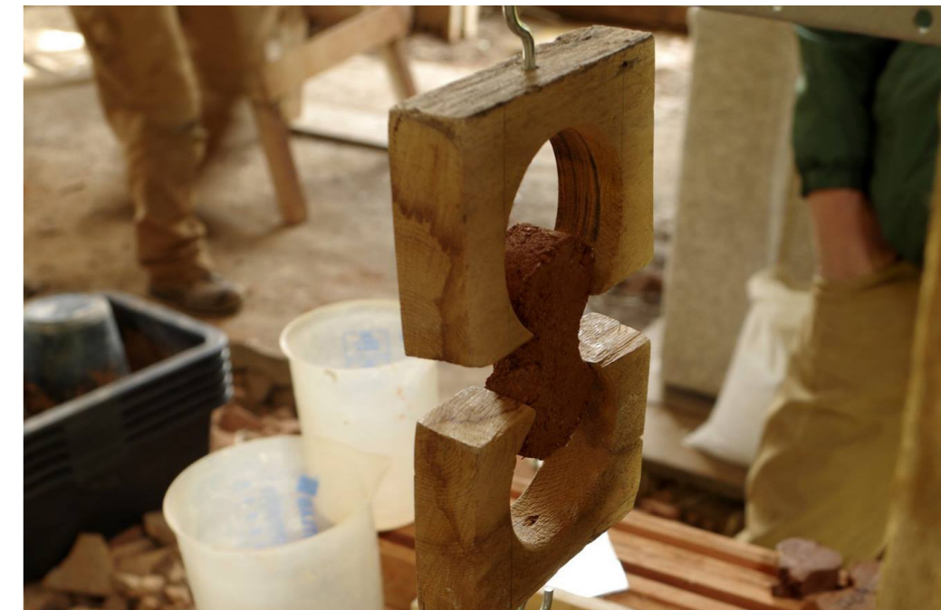
Ülal segu tõmbetugevuse määramine ning all taastatud savisein
