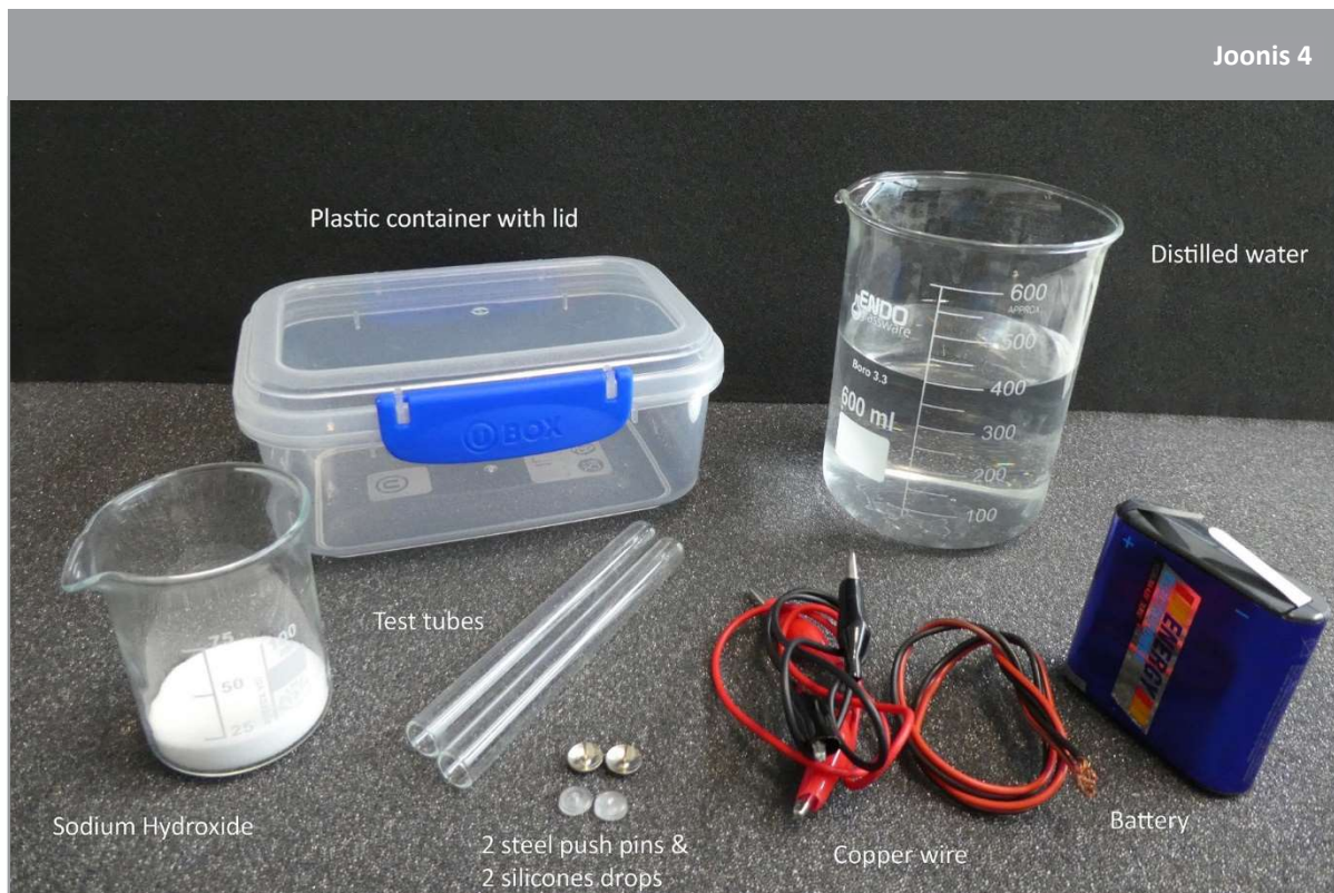
↑ Elektrolüüsiseadme ehitamiseks vajalikud vahendid
