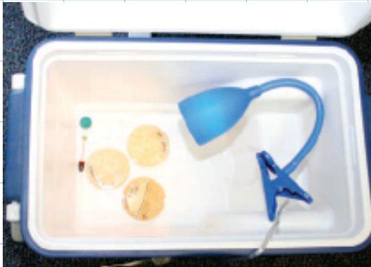
Joonis 1. Soojaruumi näidis A tugevate seintega kast
