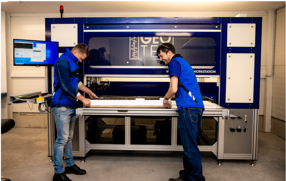
Joonis 1. Puursüdamike laadimine skaneerimisjaama MSCL-XYZ
