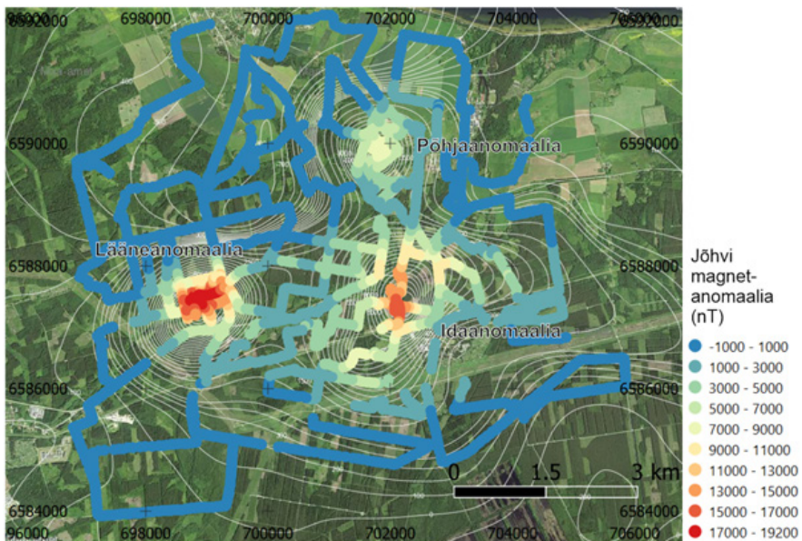
Joonis 2. Jõhvi magnetanomaalia (värvilised jooned) Maa-ameti ortofoto taustal. Valgete joonte abil on toodud aeromagnetilise andmestiku interpretatsioon.
