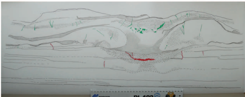
Joonis 4. Kihilisuseriketega paeplaadi tagakülje joonis, tingmärgid vt joonis 3 (Ülo Kestlase teostus).
