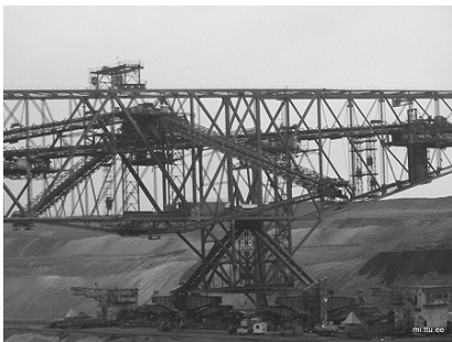
Joonis 7. Puistangusild (ülal) ja puistangusilla alusvanker (all vasakul). Joonis 8. Puistur (all paremal).
