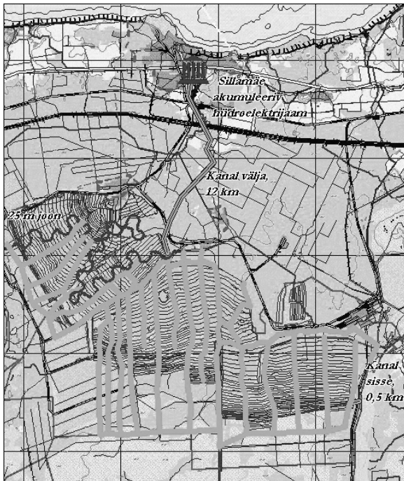
Joonis 3. Narva põlvkivikarjääri moodustuva karjäärijärvestiku skeem võimaliku akumulatsioonihüdroelektrijaamaga.
