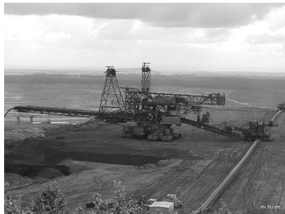
Joonis 7. Puistangusild (ülal) ja puistangusilla alusvanker (all vasakul). Joonis 8. Puistur (all paremal).
