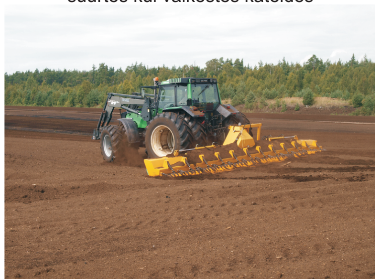
Freesturvast toodetakse turba lahtifreesimisel. Kuivamise järel vallitatakse ja kogutakse
