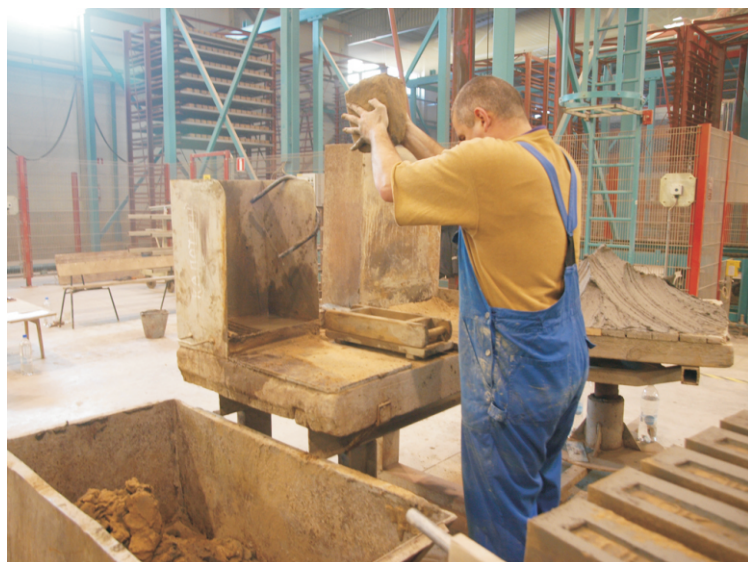
Käsitsi telliste valmistamine Wienerberger Aseri tehases
