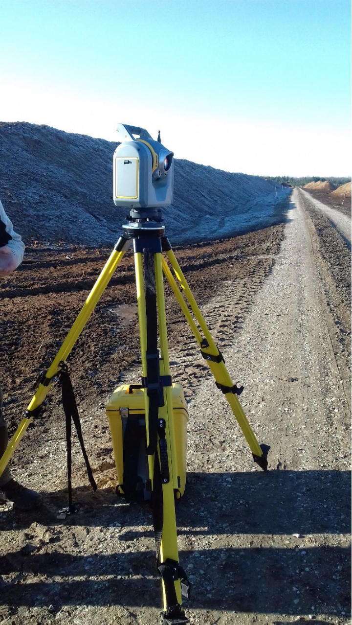
Skaneeriv tahhümeeter Trimble SX10 Laiküla turbamaardlas.
