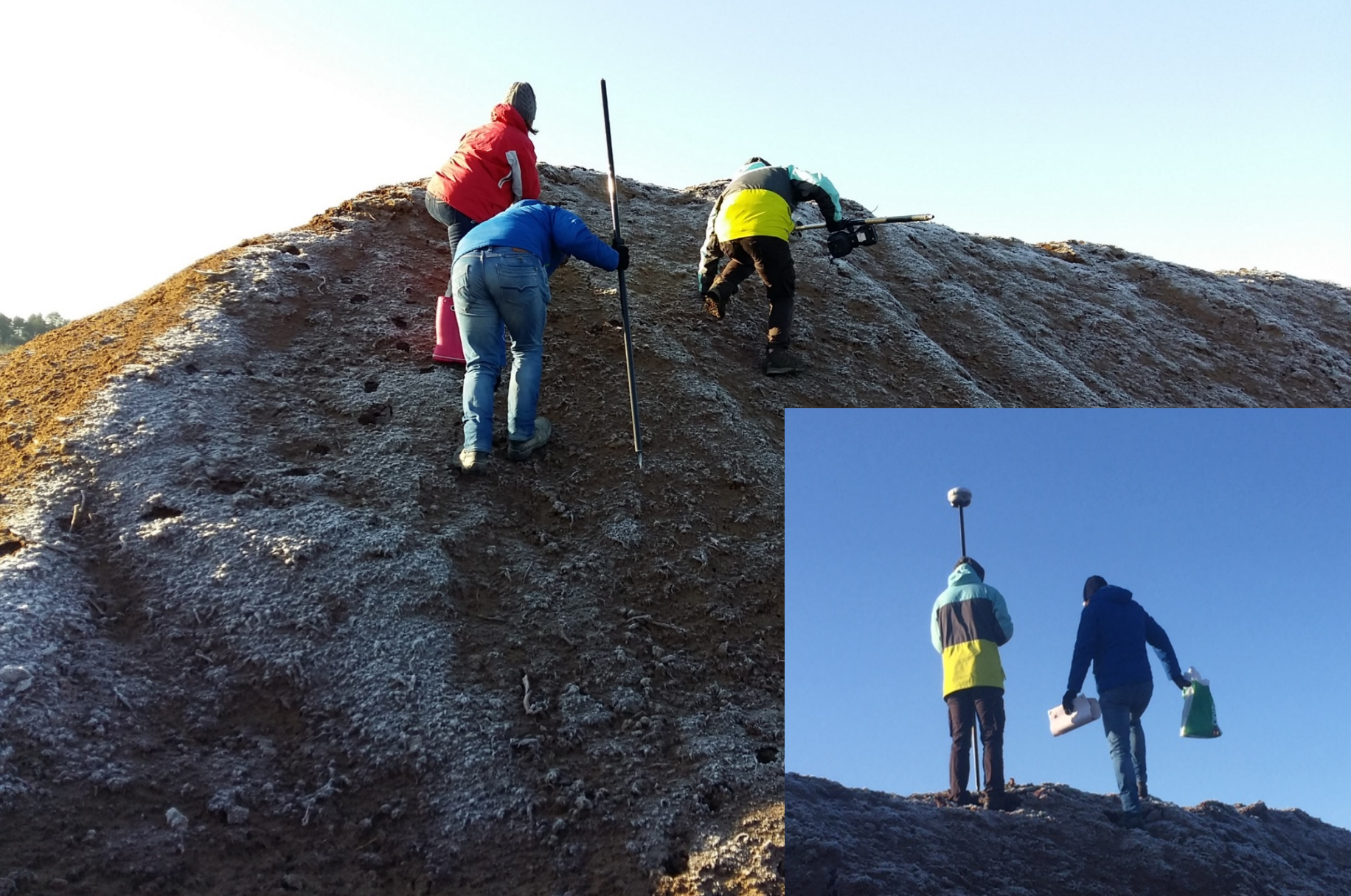
Tähiste paigaldamine ja GNSS mõõdistus. (Fotod: Mart Rae)
