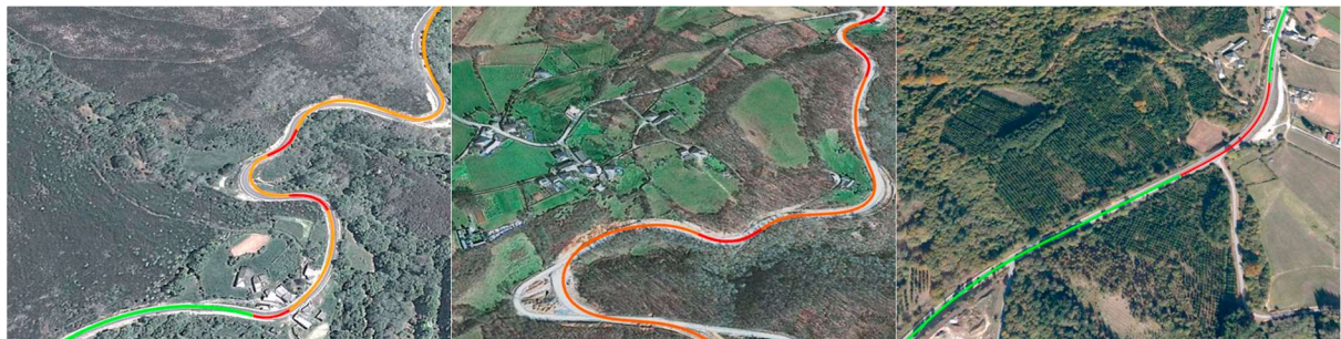
Joonis 3.35. Ohutuse kaardistamine läbi sõidutee telgjoone jagamise üksikuteks lõikudeks. Punane joon: kõrge riskimäär. Oranž joon: keskmine riskimäär. Roheline joon: madal riskimäär. (allikas: Martin-Jiménez et al., 2018)
