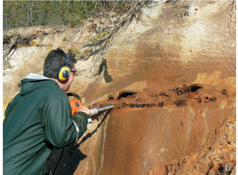
Proovide võtmine paleomagnetismi määramiseks, Kooskora karjäär (foto U. Preeden)
