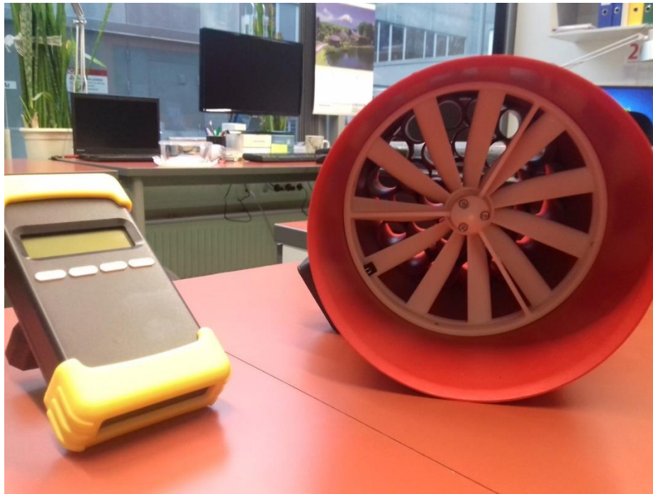
Joonis 1 OÜ Tauria poolt valmistatud referentsmõõtevahendi rolli täitev tiivikanemomeeter koos kontrolloriga (vasakul)
