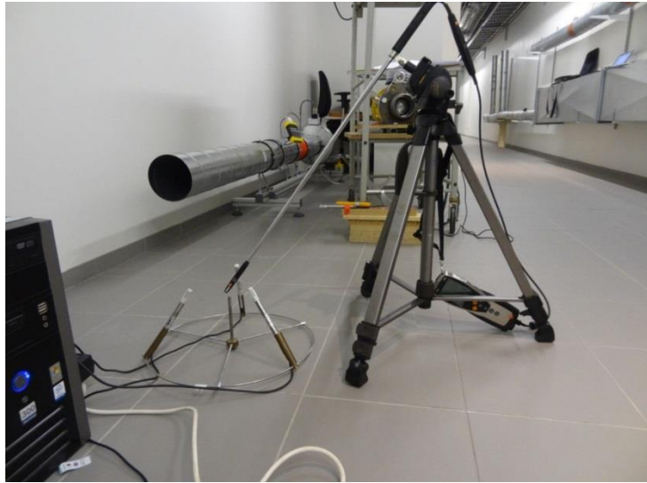
Joonis 4 Õhu temperatuuri ja suhtelise niiskuse võrdlusmõõtmine kõrgusel 10 cm põrandast. Rõngale on kinnitatud kolm referentshügroomeetrit ja nende vahele on mõõtja asetanud oma mõõtevahendi mõõtepea
