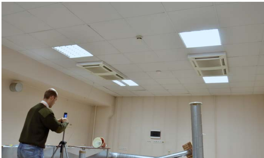
Foto 6. Keemialabori laes olevate konditsioneerimisseadmete tekitatud mürataseme mõõtmine põrandale märgitud punktide kohal 1,5 m kõrgusel (ülesanne Vent 5).
