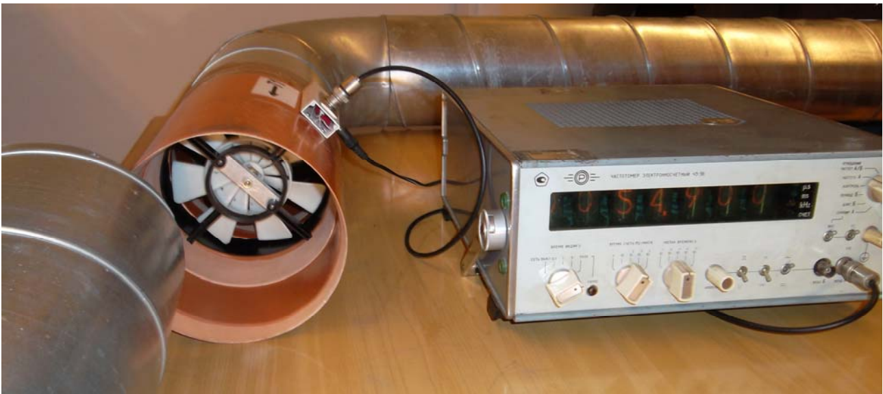
Foto 5. Kanalisse paigutatud tiivikanemomeeter ja tema juurde kuuluv sagedusmõõtur, mille näit on suurtes piirides ligikaudu võrdeline tiivikut läbiva õhuvooga.
