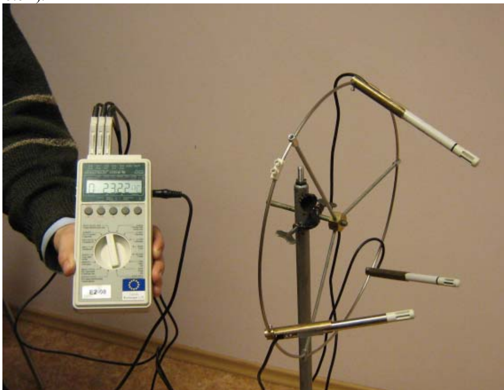
Foto 1. Kolme sensori paigutus statiivil õhutamperatuuri ja -niiskuse referentsväärtuse määramiseks
