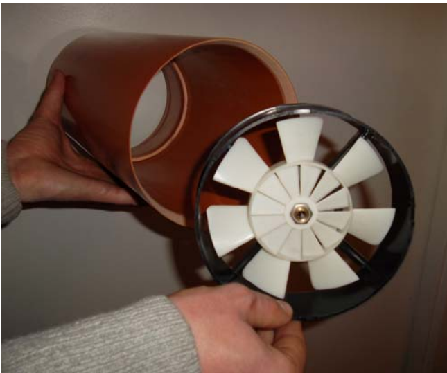
Foto 4. Plasttoru välismõõduga Ø160 mm, mille sisse õhutihedalt kinnitatakse spetsiaalne tiivikanemomeeter. Need kokkumonteeritult sobituvad õhutihedalt standardsesse ventilat-sioonikanalisse Ø160 mm (Fotol 5.)
