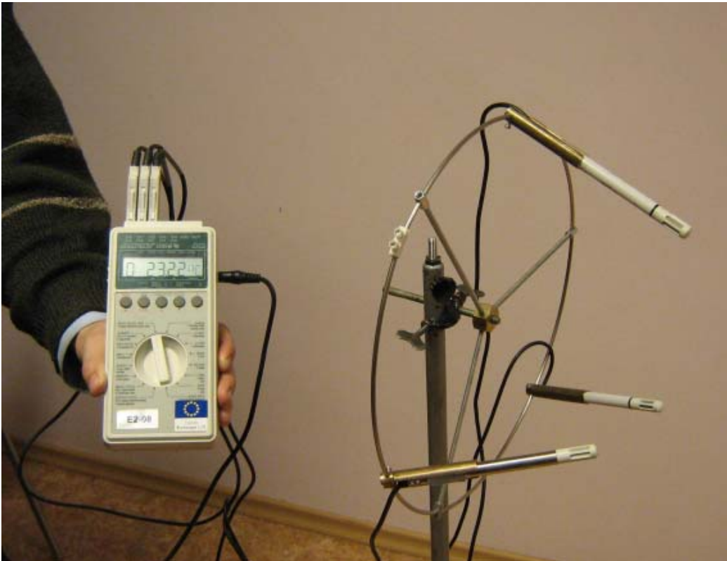
Foto 1 Tööetaloni kolme sensori paigutus statiivil õhutemperatuuri ja -niiskuse referentsväärtuse määramiseks
