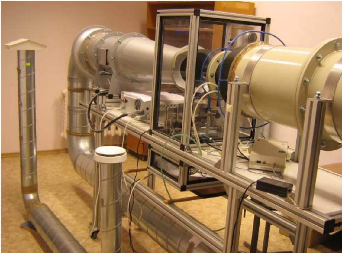
Foto 2. Tuuletunnel ja osa sissepuhkesüsteemist.
