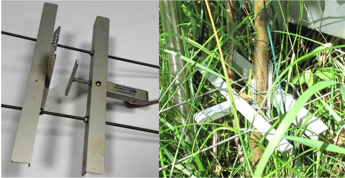
Joonis 6. Projekti raames ostetud DD-L tüüpi tüve diameetri dendromeeter
